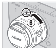
Utrzymując oznaczenia dopasowane, załóż obiektyw na aparat, a następnie przekręcaj go, aż zatrzaśnie się w poprawnym położeniu.
