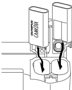
5 Falls Sie Lithiumbatterieblöcke verwenden
