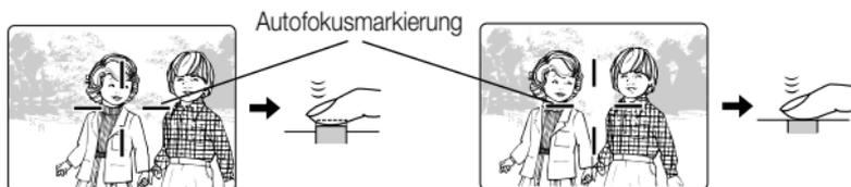
Positionieren Sie das Hauptobjekt innerhalb der Autofokusmarkierung, und drücken Sie den Auslöser halb herunter.
