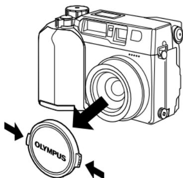
Para activar la alimentación de la cámara, retire la tapa del objetivo y ajuste el disco de modo a cualquier ajuste excepto OFF.
