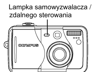
Lampka samowyzwalacza / zdalnego sterowania
