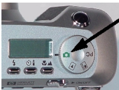
Ilustracja 1. Wprowadzenie aparatu w tryb Capture.
