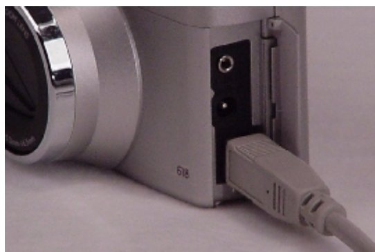
Ilustracja 25. Podłączanie kabla USB do aparatu.
