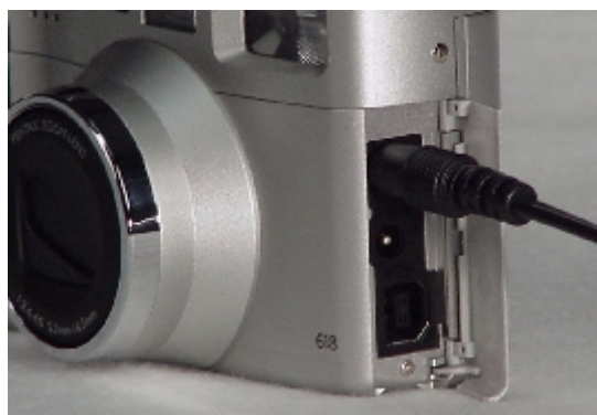
Ilustracja 27. Podłączanie kabla video do aparatu.
