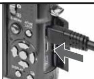
Parça kablosunu kamera üzerinde bulunan COM- PONENT OUT soketine takın
