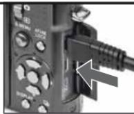
Ligação do cabo componente à SAÍDA DA COMPONENTE da câmara
