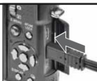
AV kablosunu kamera üzerinde bulunan AV OUT/DIGITAL soketine takın
