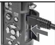
Sæt Component-kablet i kameraets COMPONENT OUT-bøsning
