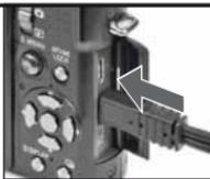
Podłącz kabel AV do gniazda AV OUT/DIGITAL w aparacie
