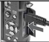
Podłącz kabel komponentowy do gniazda COMPO-
