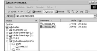
In den **100 LEICA-**, **101 LEICA-**, u.s.w. -Ordnern können bis zu 999 Aufnahmen gespeichert werden. Im **MISC**-Ordner können Aufnahmen mit Druckauftrags-Einstellungen (DPOF) gespeichert werden. Im **PRIVATE1**-Ordner werden die Trickfilm-Dateien gespeichert
