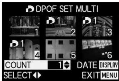
Mit der **DISPLAY**-Taste (1.22) kann bei der Gelegenheit auch festgelegt werden, dass das Datum, an dem die Aufnahmen erstellt wurden, auf den gedruckten Bildern erscheint.
