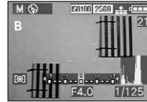
**B:** Die Mehrzahl der Pixel weisen mittlere Helligkeiten auf: korrekte Belichtung
