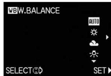
2. Die untereinander angeordneten Funktionsvarianten entsprechen bis auf die Anordnung genau denjenigen in den normalen Menüpunkten. Sie können jetzt durch Drehen des zentralen Einstellrades besonders schnell und einfach eingestellt werden.
